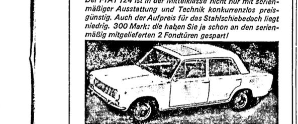
1197 cm - 60 PS - Höchstgeschwindigkeit 145 km/h - fünfgangige Kurbelwelle - 4 Scheibenbremsen - Knüppelschaltung - vollsynchr. 4-Ganggetriebe - Zweifachhorn - Einzelleuchte vorn - vier Türen, die hinteren mit doppelter Sicherheitsverriegelung.
