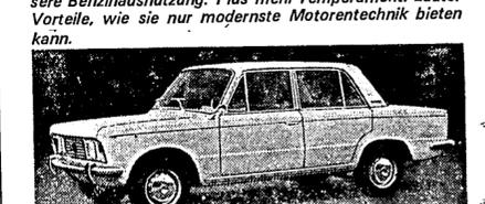
1597 ccm - 90 PS - Höchstgeschwindigkeit 160 km/h - zwei obenliegende Nockenwellen - fünfmal gelegerte Kurbelwelle - Wechselstrom-Lichtmaschine - vier Servo-Schalbenbremsen - Wischer und Gebläse zweistufig - Einzel- und Liegesitze vorn - vier Türen, die vordere abschließbar, die hinteren mit doppelter Sicherheitsverriegelung - Unterbodenschutz.
