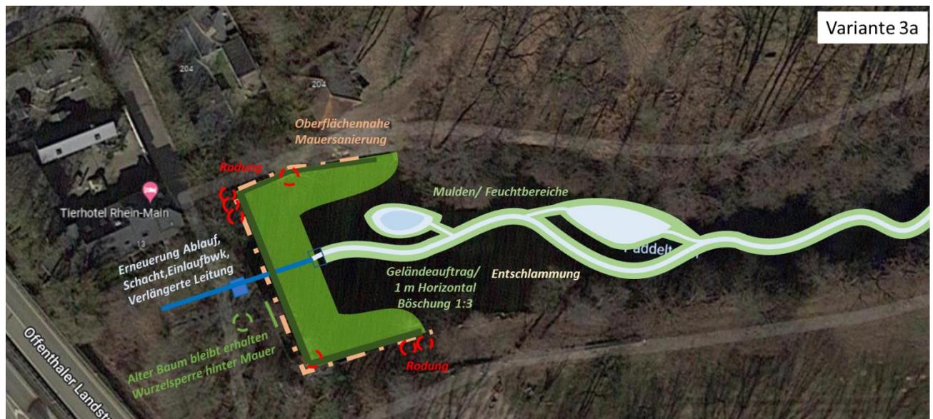
Abbildung 25: Skizzenhafte Darstellung Variante 3a: Naturnahe Umgestaltung mit Böschungen
